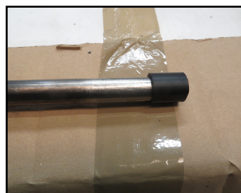
Mettre l'isolant phonique au bout de la résistance.
