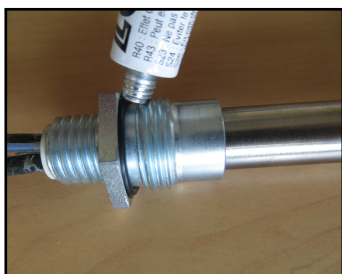
Mettre la pâte Loctite 5900 (double étanchéité en plus du joint) sur le premier filet et sur un tour.
