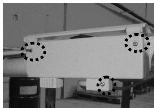
Lösen Sie die drei Schrauben mithilfe eines Torx-Schraubendrehers.
