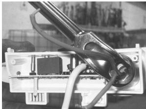
Positionieren Sie Regelgehäuse und Mutter an der richtigen Stelle und ziehen Sie die Mutter fest.
