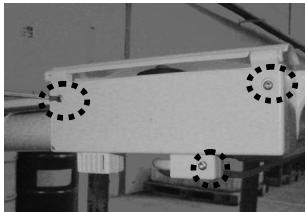
Met behulp van de torx schroevendraaier verwijdert u de drie schroeven.
