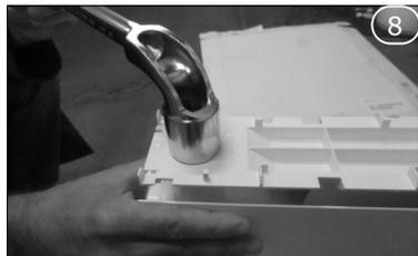
Dévisser l'écrou qui maintient la résistance avec une clé à pipe de 27.
