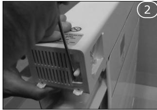
Appuyer sur le clips sous la sonde de température.
