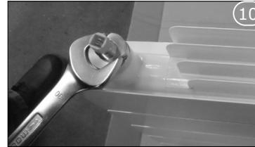
Débloquer la résistance avec la clé de 30 (attention à bien garder l'appareil stable afin d'éviter toute projection d'huile). Finir de dévisser la résistance manuellement.
