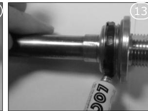
Déposer la pâte d'étanchéité sur la résistance neuve.
