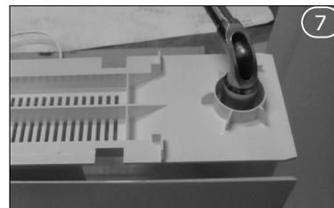
Dévisser l'écrou situé en haut de l'appareil avec une clé à pipe de 13.
