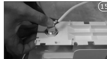
Remettre le support joue en place. Revisser en haut et en bas du support sans oublier la rondelle en partie supérieure. Rebrancher soigneusement la résistance en appuyant sur le connecteur.
