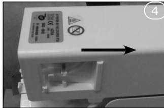
Décaler la joue de quelques millimètres vers le haut de l'appareil.
