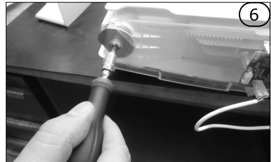
De kant tegenover de weerstand los draaien met de binnenzeskantsleutel.
