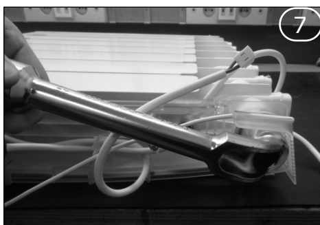
De moer aan de linkerkant deblokken met de sleutel van 27.
