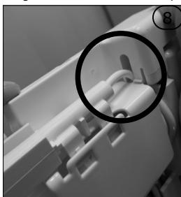
Reclicer la sonde de température en faisant passer le câble sur le support arrondi prévu à cet effet [7]. Insérer ce câble dans l'ouverture de la coque prévue à cet effet [8] lors de la remise en place de celle-ci. Clipser puis revisser la coque.
