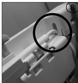
De temperatuursonde weer vastmaken door de kabel over de daarvoor bestemde ronde steun [7] te leiden. Steek deze kabel in de daarvoor bestemde kapopening [8] wanneer u hem vervangt. De kap vastklemmen en vastschroeven.
