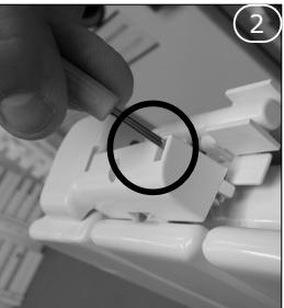
Mithilfe eines Kreuzschlitzschraubendrehers lösen [1].
