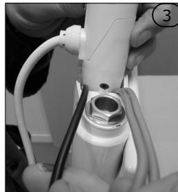
De ontvanger in de kap steken. **LET OP** dat de kabels goed worden gescheiden voor de doorvoer van de ontvanger in de kap: de 2 blauwe kabels aan de ene kant en de zwarte kabel aan de andere kant.
