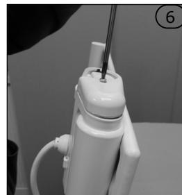
Revisser la partie inférieure de la coque du récepteur cylindrique à l'aide du tournevis torx T10.
