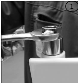
De weerstand deblokken met de sleutel van 24 (let op dat het apparaat stabiel blijft, om oliespaten te voorkomen). Draai de weerstand verder los met de hand.
