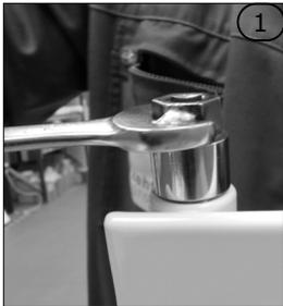
Lösen Sie den Widerstand mithilfe eines Maulschlüssels der Größe 24 an. Sie das Gerät dabei in einer stabilen Position, um jegliches Verschütten von Öl zu verhindern.
