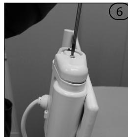
Den unteren Teil der Gehäuseschale des zylindrischen Empfängers mit einem Torx-Schraubendreher T10 festschrauben.
