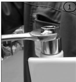
Débloquer la résistance avec la clé de 24 (attention à bien garder l'appareil stable afin d'éviter toute projection d'huile). Finir de dévisser la résistance manuellement. Retirer la résistance en essuyant l'huile.
