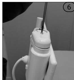
Het onderste gedeelte van de kap van de cilindervormige ontvanger vastschroeven met een torx-schroevendraaier T10.
