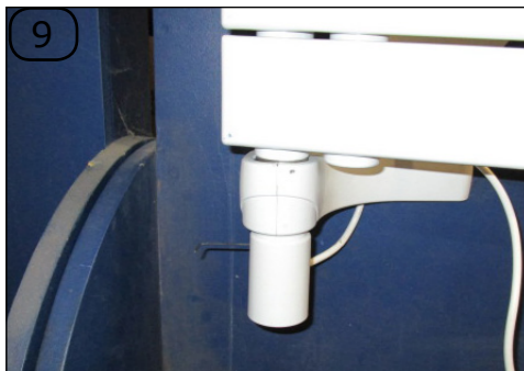
Lösen Sie den Kunststoffkopf der Heizpatrone mit einem 1,5er Innensechskantschlüssel. Ziehen Sie den Heizpatronenkopf inklusive des daran befestigten Stromkabels ab.
