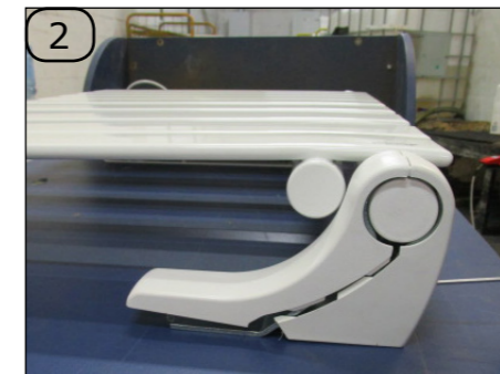
Démonter le cache-fixation en plastique en séparant les deux parties à l'aide du tournevis Torx T10.
