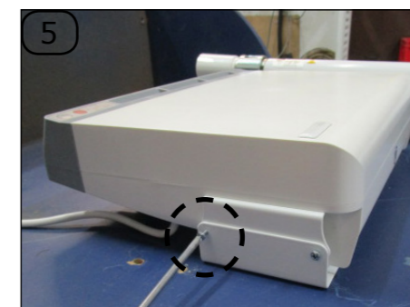
Ouvrir l'appareil et dévisser la vis du bas de chaque côté de la platine de fixation murale (partie soufflant) à l'aide du tournevis cruciforme.
