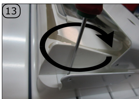
Schrauben Sie die Metallwinkel mit den vier mitgelieferten Schrauben an den neuen Heizlüfter an.
