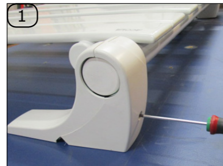
Démonter le cache-fixation en plastique en séparant les deux parties à l'aide du tournevis Torx T10.
