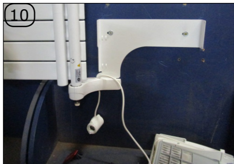
Dévisser les oreilles métalliques de chaque côté du soufflant avec un tournevis Torx T10 et conserver celles-ci pour le remontage.
