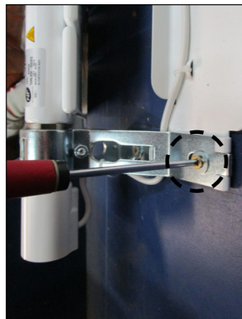
7 Lösen Sie die 4 „sichtbaren“ Schrauben vollständig (zwei Schrauben oben an der Halterung und jeweils eine weitere Schraube an der Drehhalterung oben und unten).
