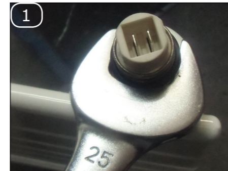
1 Stellen Sie den Heizkörper immer so ab, dass die Heizpatrone nach oben zeigt, um zu verhindern, dass Öl ausläuft.
