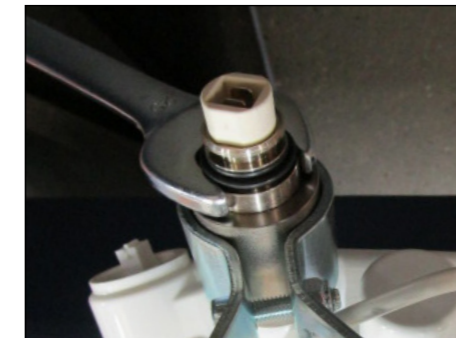
2 Lösen Sie die Heizpatrone mithilfe eines Maulschlüssels der Größe 25 an. Schrauben Sie die Heizpatrone mit der Hand vollständig heraus.
