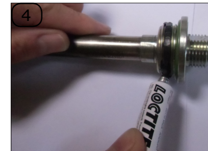
4 Tragen Sie Dichtungsmasse auf die neue Heizpatrone auf.
