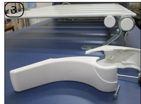
Démonter le cache-fixation en plastique en séparant les deux parties à l'aide du tournevis Torx T10.
