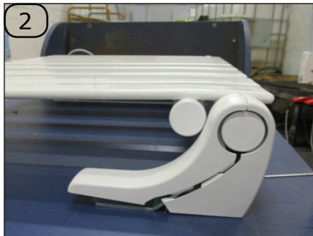
1 Entfernen Sie die Kunststoffabdeckung der oberen Befestigung, indem Sie die zwei Teile mithilfe des Torx-Schraubendrehers voneinander trennen.
