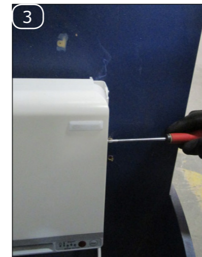
Désolidariser le soufflant de sa platine en dévissant les deux oreilles en métal avec le tournevis cruciforme.
