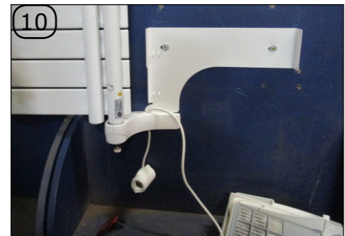
Lösen Sie den Kunststoffkopf der Heizpatrone mit einem 1,5er Innensechskantschlüssel. Ziehen Sie den Heizpatronenkopf inklusive des daran befestigten Stromkabels ab.
