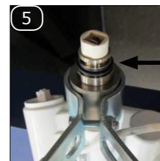
5 Führen Sie die Heizpatrone in die dafür vorgesehene Öffnung ein. Ziehen Sie die Heizpatrone mithilfe eines Drehmomentschlüssels auf 50 Nm an. Überprüfen Sie, dass die Heizpatrone mit zwei Dichtungsringen versehen ist.
