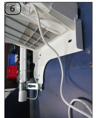
Il est maintenant possible de faire pivoter le soufflant afin d'accéder à la platine de fixation murale.
