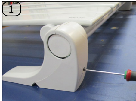
1 Entfernen Sie die Kunststoffabdeckung der oberen Befestigung, indem Sie die zwei Teile mithilfe des Torx-Schraubendrehers voneinander trennen.
