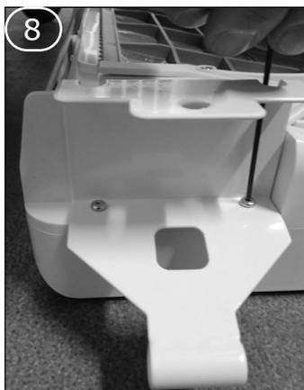
Dévisser la platine métallique du soufflant avec un tournevis Torx T10.
