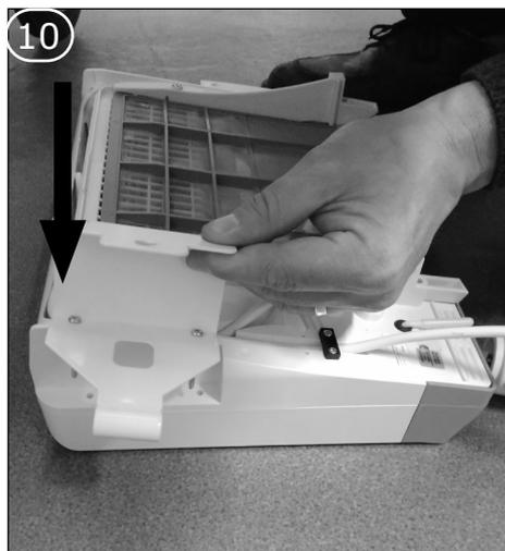
Poser la platine simple du même côté que sur l'ancien soufflant, puis la visser à l'aide des 2 vis Torx T10.
