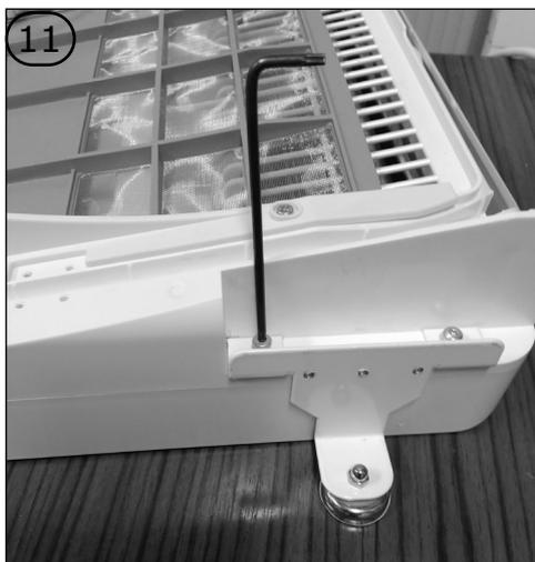
Poser la platine avec aimant du même côté que sur l'ancien soufflant, puis la visser à l'aide des 2 vis Torx T10.
