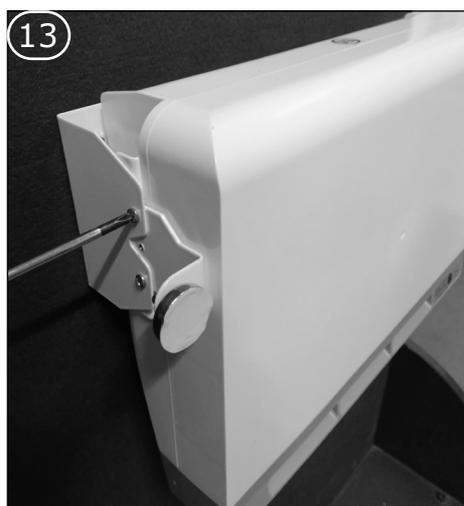
Refermer le soufflant en position et revisser les 2 vis cruciformes et la vis de bridage (voir points 5 et 6).
