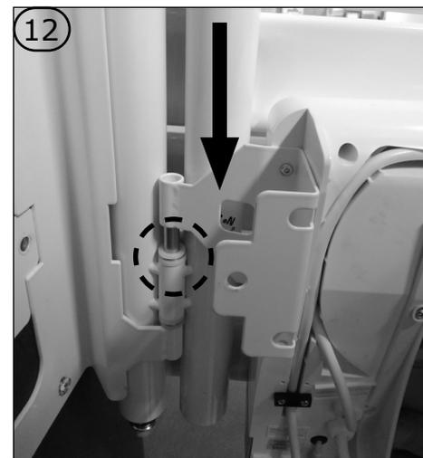
Reposer le soufflant sur sa charnière en s'assurant que les rondelles plastiques soient toujours en place.
